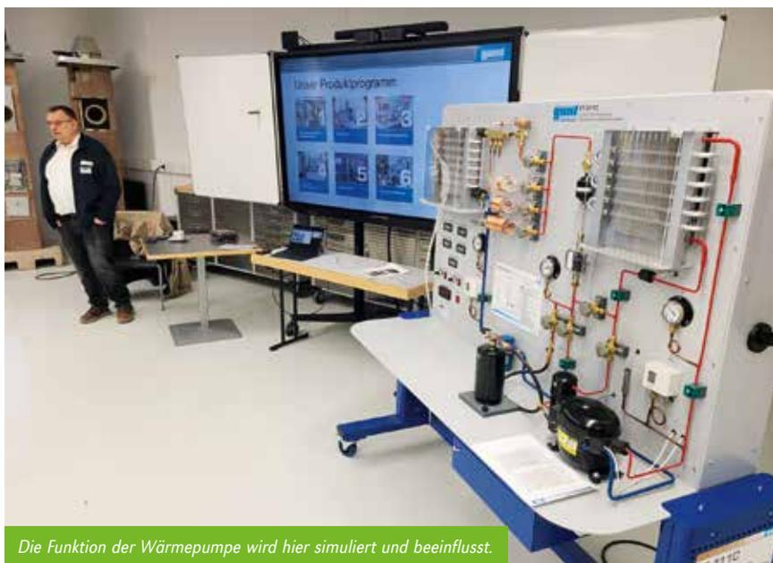
Die Funktion der Wärmepumpe wird hier simuliert und beeinflusst.
